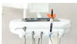
Fotopolimerizador acoplado, com radiômetro incorporado.
